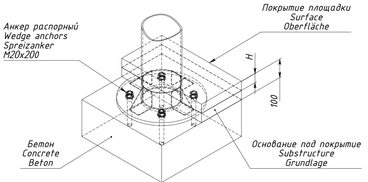
$H$  — толщина ударопоглощающего покрытия площадки
