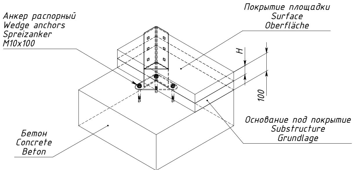
$H$  — толщина ударопоглощающего покрытия площадки
