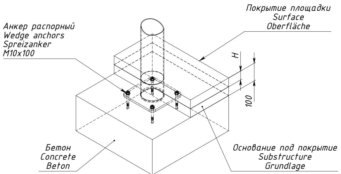
$H$  — толщина ударопоглощающего покрытия площадки
