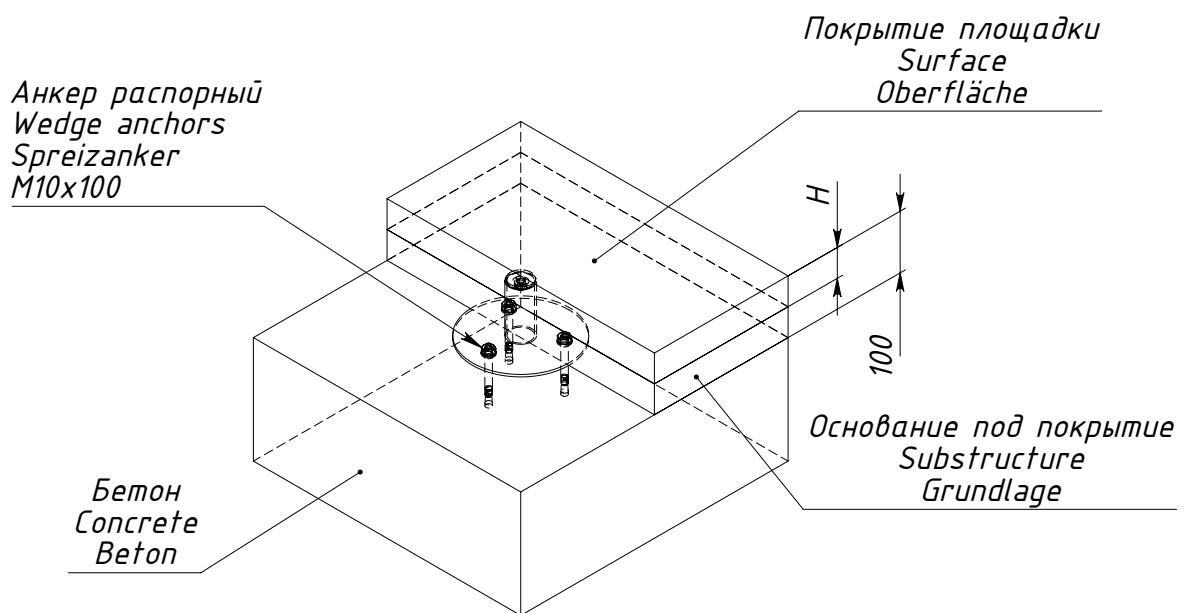
$H$  — толщина ударопоглощающего покрытия площадки
