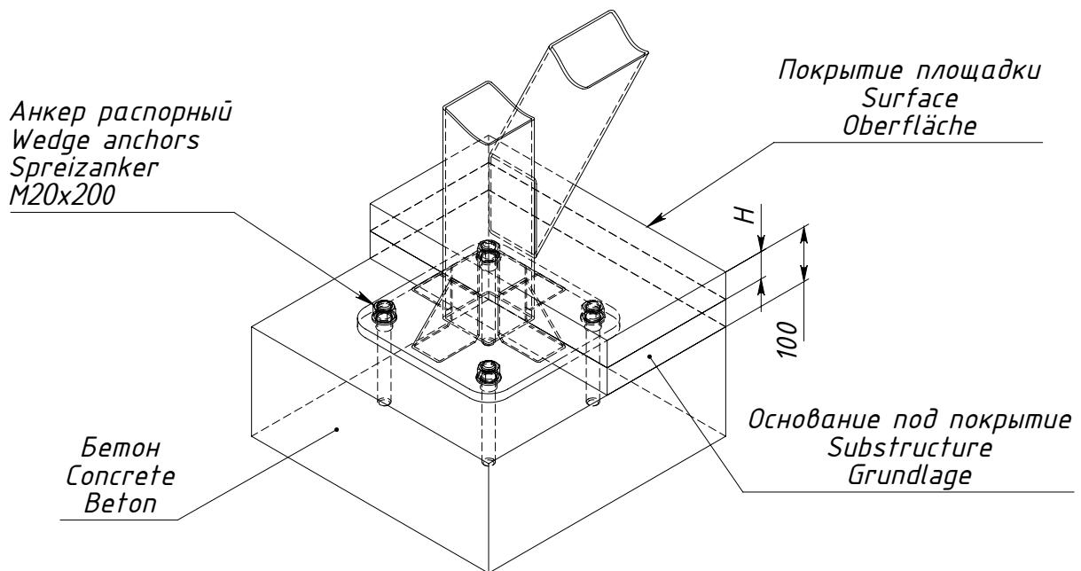
$H$  — толщина ударопоглощающего покрытия площадки
