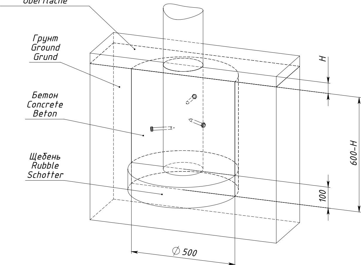
$H$  — толщина ударопоглощающего покрытия площадки
