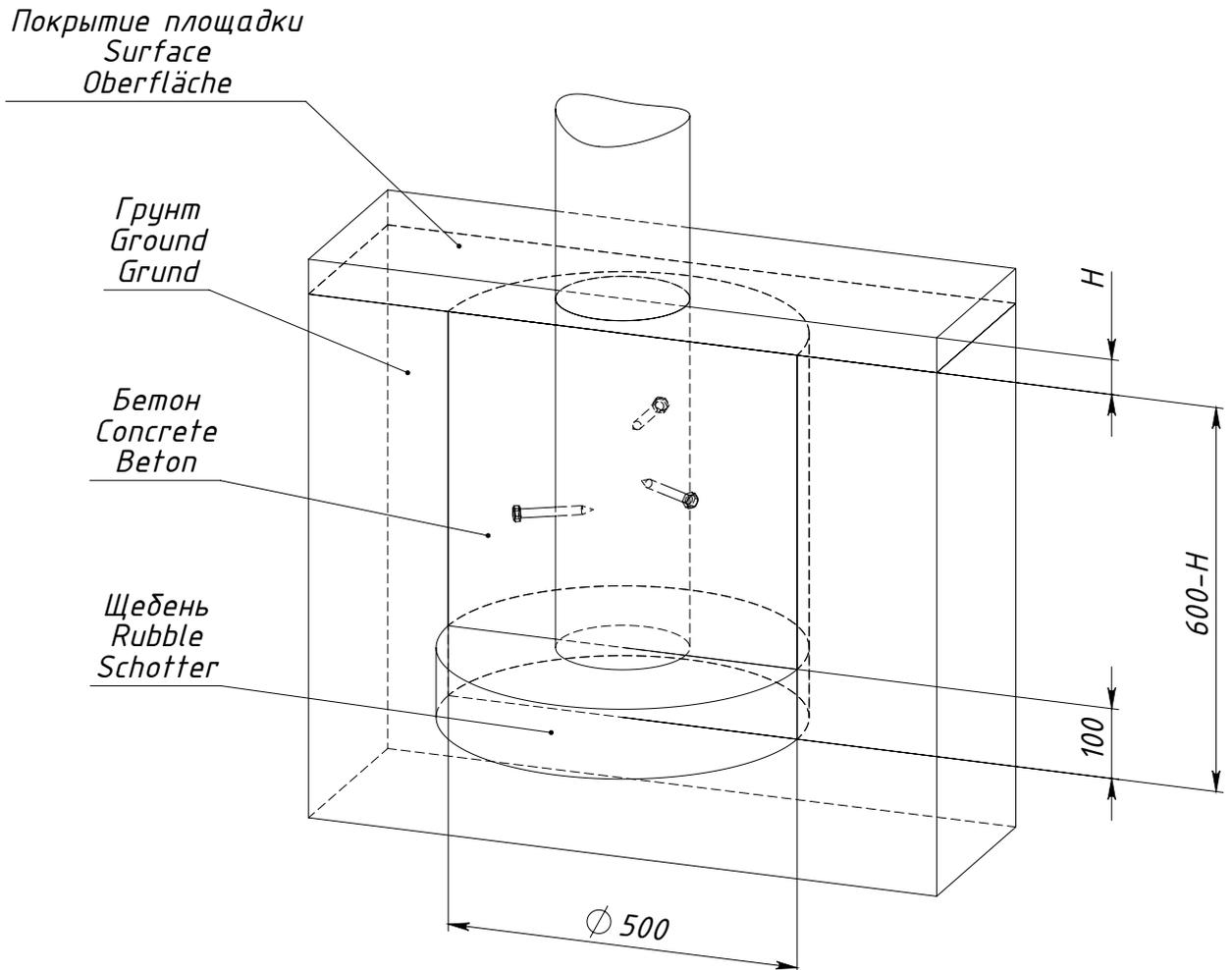
$H$  — толщина ударопоглощающего покрытия площадки
