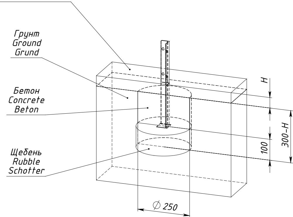
$H$  — толщина ударопоглощающего покрытия площадки
