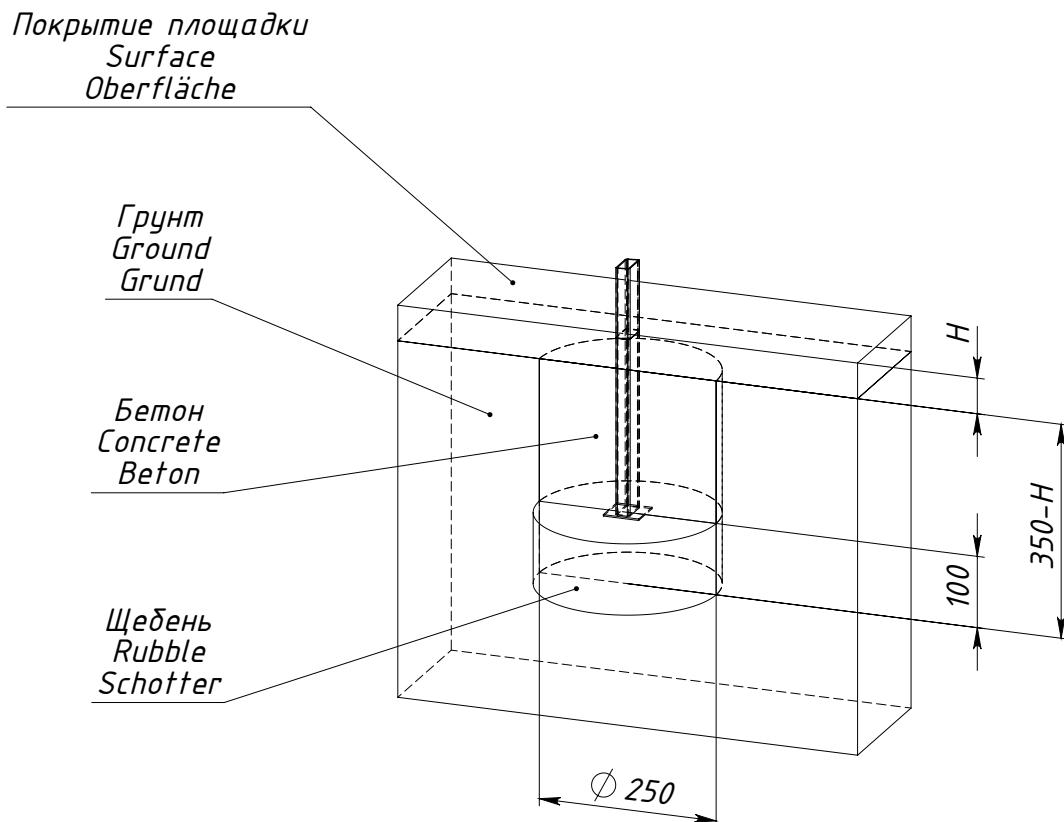
$H$  — толщина ударопоглощающего покрытия площадки
