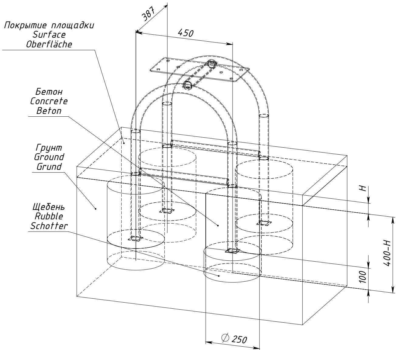
$H$  — толщина ударопоглощающего покрытия площадки
