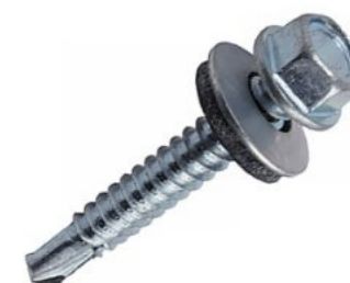
SH5` 5.032.D7504K (Винт самонар. с буром, шайбой EPDM, 5,5×32, DIN 7504K) — 96 шт
