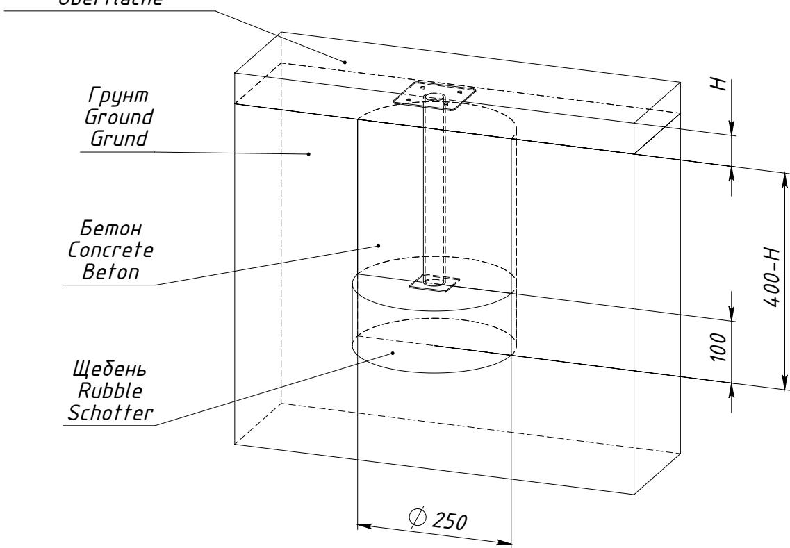
*H — толщина ударопоглощающего покрытия площадки*
