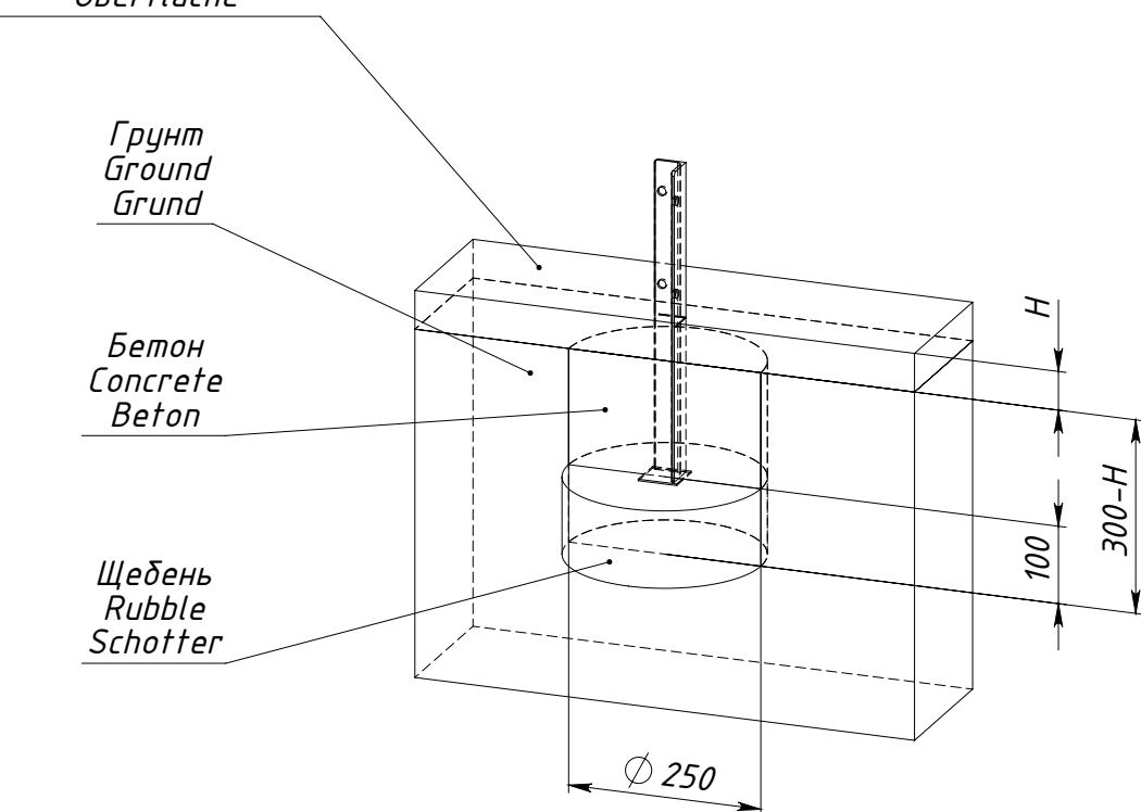
$H$  — толщина ударопоглощающего покрытия площадки
