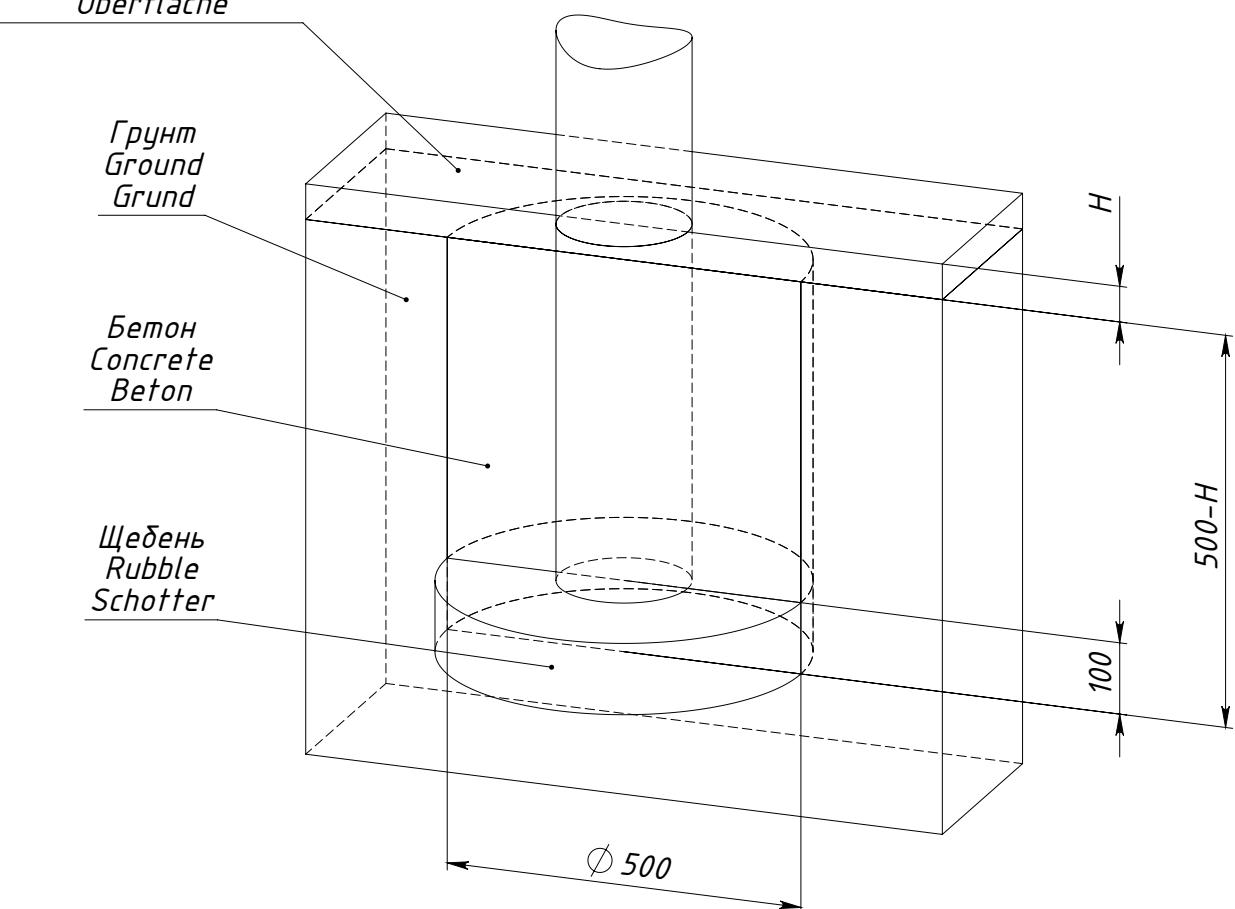
$H$  — толщина ударопоглощающего покрытия площадки
