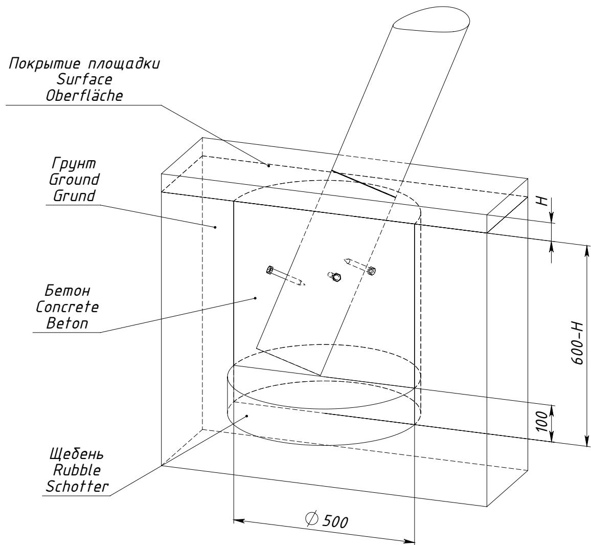
$H$  — толщина ударопоглощающего покрытия площадки
