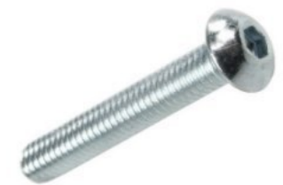
BO10.020.D7380 (Болт полусфер., с внутр. шестигр., М10×20, DIN 7380) — 5 шт
