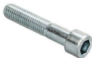
BC10.035.D912 (Болт с внутр. шестигр., М10×35, DIN 912) — 100 шт
