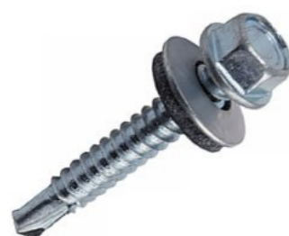
SH4` 8.060.D7504K (Винт самонар. с буром, шайбой EPDM, 4,8×60, DIN 7504K) — 16 шт
