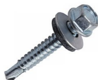
SH5` 5.032.D7504K (Винт самонар. с буром, шайбой EPDM, 5,5×32, DIN 7504K) — 48 шт
