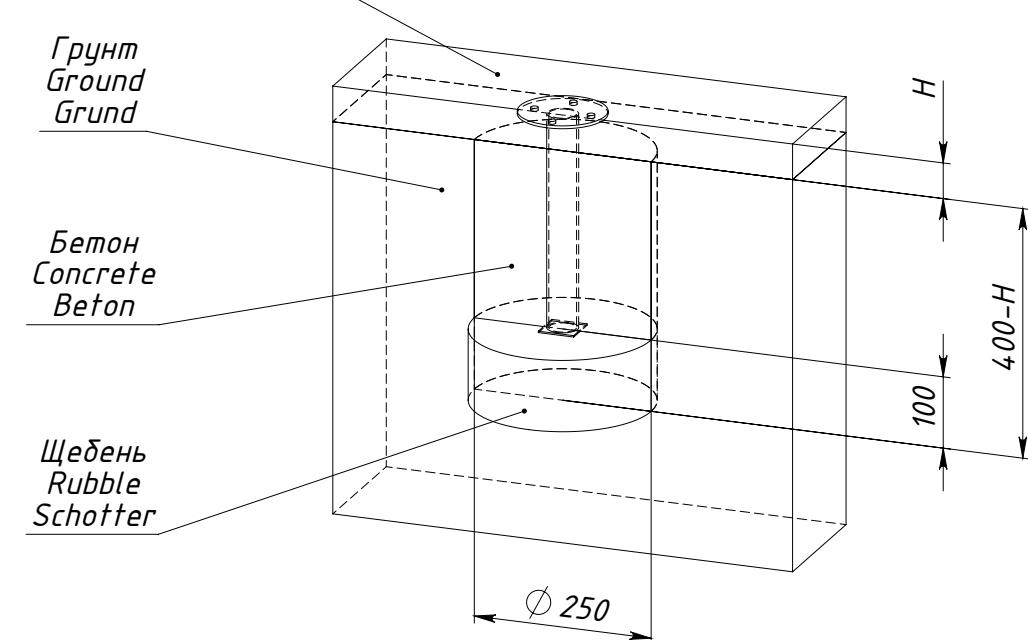
$H$  — толщина ударопоглощающего покрытия площадки
