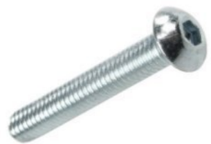
BO10.020.D7380 (Болт полусфер., с внутр. шестигр., M10×20, DIN 7380) — 3 шт
